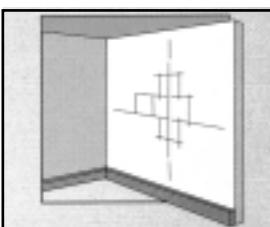
Nacrtajte mesto prve ploče (prvih ploča), tako, da najpovoljnije naleže na postavljene vertikale i horizontale.
