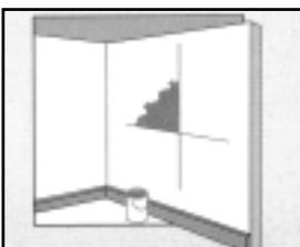
Pomoću valjaka ili četke nanesite ravnomerno lepak na površinu zida i na poleđinu ploče koju želite zalepiti. Ostavite, da se lepak suši na obe površine, a zatim zalepite ploču na zid.
