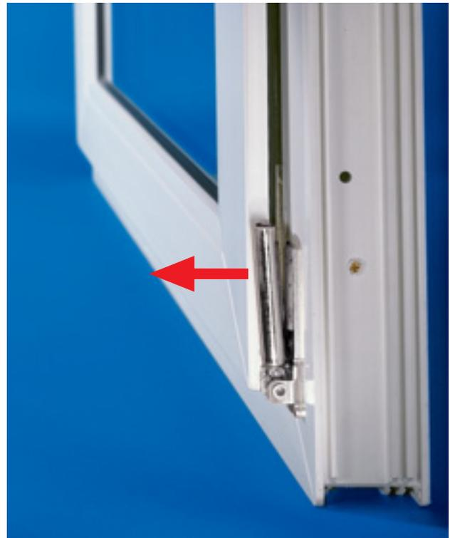
**Parallel-Abstell-Fenster:** Bei dem patentierten Beschlagkonzept "Lüften mit Sicherheit" wird statt der bei Drehkipp-Fenstern üblichen Kippstellung der gesamte Fensterflügel zum Lüften ca. 6 mm parallel zum Rahmen abgestellt.
