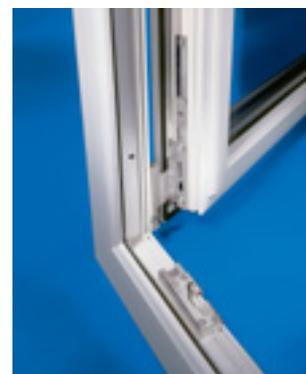
Hochfeste Pilzbolzen greifen sowohl in der Verschluss- als auch in der Lüftungs-Stellung in die Rahmenteile aus gehärtetem Stahl und sorgen für erheblichen Widerstand im Einbruchfall.
