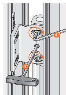
Mit zweitem Inbus-schlüssel Befesti-gungsschrauben wieder anziehen (9–11 Nm).
