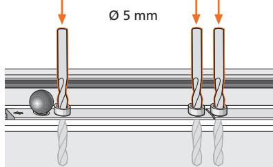
Befestigungsplatte einsetzen und festschrauben (max. 7 Nm).
