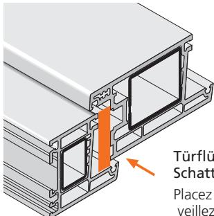
Türflügel in Rahmen einsetzen, Schattennut sichern (kl. Abb.).
