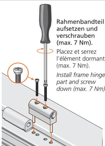
Rahmenbandteil aufsetzen und verschrauben (max. 7 Nm).
