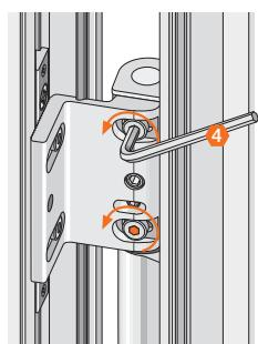
Befestigungs-schrauben Flügelbandteil leicht lösen.
