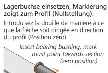
Lagerbuchse einsetzen, Markierung zeigt zum Profil (Nullstellung).
