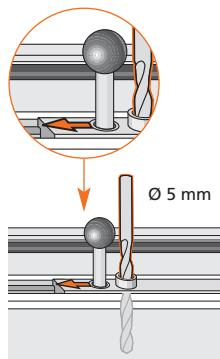
Bohrlehre für Flügel in Beschlagnut einsetzen – Pfeil zeigt Richtung Oberkante Türflügel. Markierung Bohrlehre stimmt mit Markierung Türflügel überein. Oberste Bohrung setzen.
