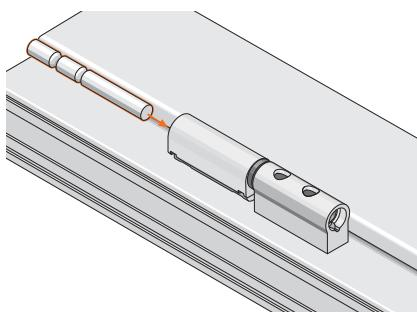
Bolzen von oben durch beide Bandteile bis Anschlag einführen.
