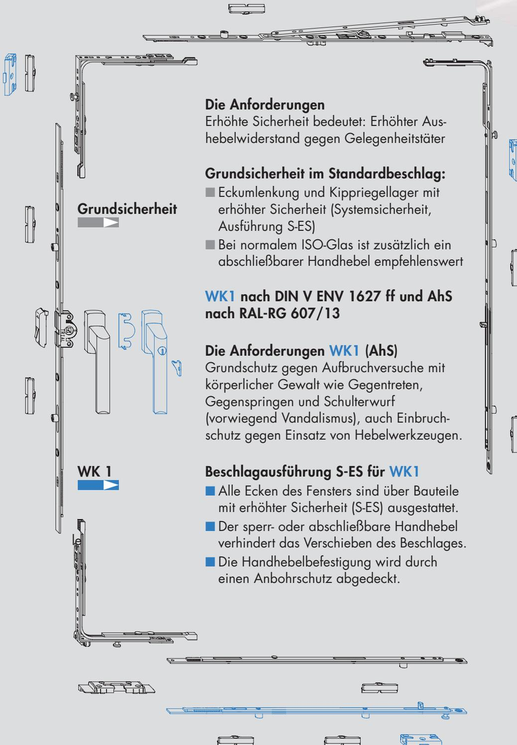
\* Die Anzahl der Standard-Schließbleche ist abhängig von der Flügelfalzhöhe und der Flügelfalzbreite.
