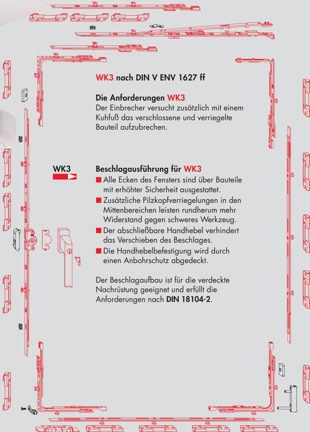
\* Die Anzahl der Standard-Schließbleche ist abhängig von der Flügelalzöhe und der Flügelalbreite.
