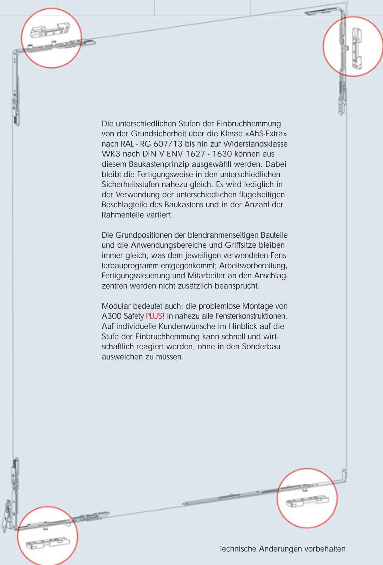
Die unterschiedlichen Stufen der Einbruchhemmung von der Grundsicherheit über die Klasse «AhS-Extra» nach RAL - RG 607/13 bis hin zur Widerstandsklasse WK3 nach DIN V ENV 1627 - 1630 können aus diesem Baukastenprinzip ausgewählt werden. Dabei bleibt die Fertigungsweise in den unterschiedlichen Sicherheitsstufen nahezu gleich. Es wird lediglich in der Verwendung der unterschiedlichen flügelseitigen Beschlagteile des Baukastens und in der Anzahl der Rahmenteile variiert.
